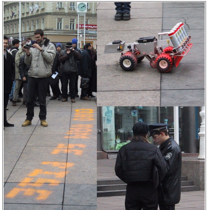
GraffitiWriter el robot grafitero desarrollado por el Instituto de Autonomía Aplicada, capaz de escribir frases en el suelo a una velocidad superior a los 20 Km/h, todo un artefacto hacktivista para intervenir en el espacio público. Las instrucciones para su construcción (incluyendo el código de software que controla los sprays que hacen de impresora) se encuentran en la web del Instituto: http://appliedautonomy.com .
